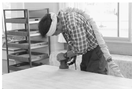
痛んだ作業機の表面を 滑らかに研磨します
