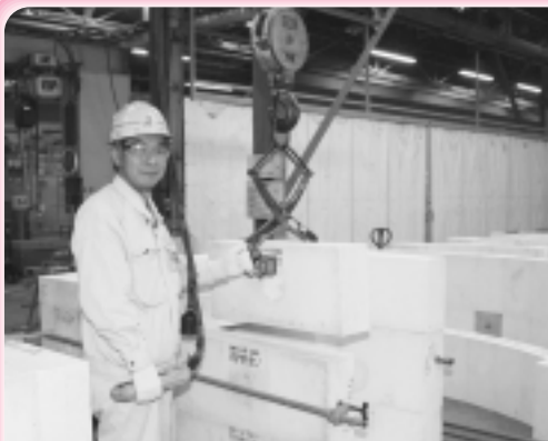
クレーンを操作してブロックを仮組立している香取さん
