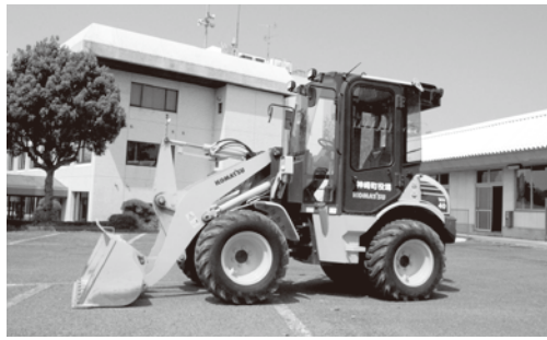
除雪に使用するホイールローダー
